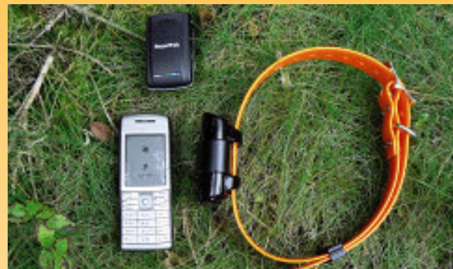
Aus drei Teilen besteht das dps von NUM'axes: Senderhalsung, GPS-Modul und Empfängerhandy von Nokia.
