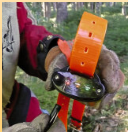
Das Ein- und Ausschalten des Senders erfolgt über einen Magnetschalter.
