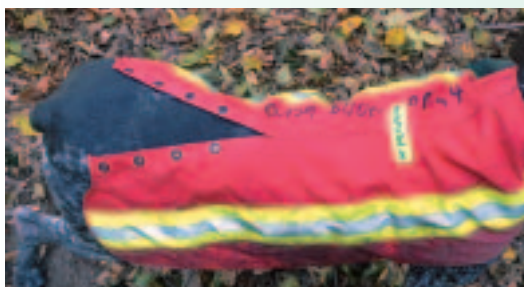
Überraschend haltbar: die Druckknopfleiste. An den Vorderläufen zeigt die Huprotex Mut zur Lücke.
